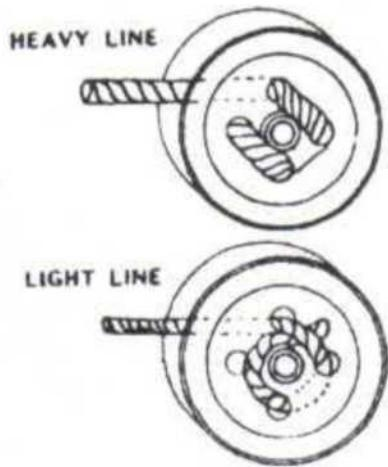
***Инструкция присоединения веревки к барабану лебедки.***
