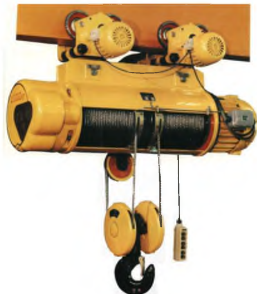
Модель CD1/MD1 Грузоподъемность 10,0 т. Высота подъема 6-30 м.
